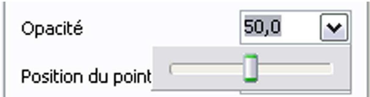
Si on réduit l'opacité à zéro, l'image est invisible. Pour revenir à 100 % d'opacité, il suffit de cliquer deux fois avec le bouton gauche de la souris dans la fenêtre des pourcentages. A 100 % d'opacité l'image est 100 % lumineuse !
